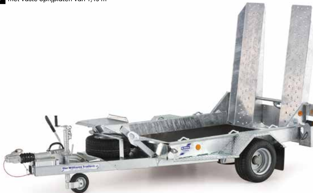
GH64 met vaste oprijplaten van 1,45 m
